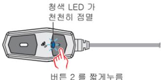
다시 버튼 2 를 누르면 청색 LED 가 점등으로 바뀌고 녹화를 재개합니다 . 차량의 엔진을 끄면 , 본제품의 전원이 OFF 가 되어 , 자동적으로 녹화를 종료합니다 .
